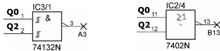
Abbildung 3.11: Zwei angeschlossene Gatter für die Decodierlogik
