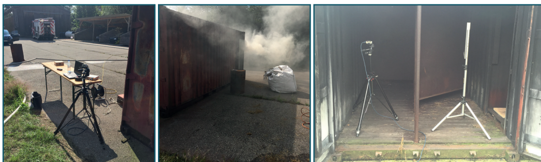
Abbildung 16: Test des Radarsensors unter realen Rauchbedingungen in der Wärmegewöhnungsanlage der Feuerwehr Reutlingen.
