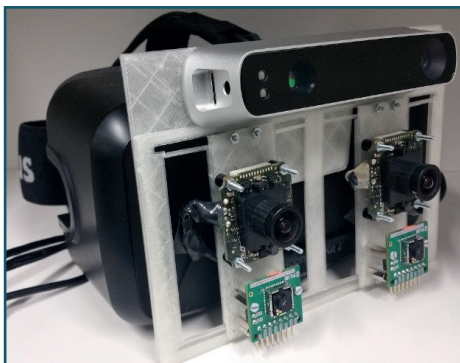
Abbildung 8: Prototyp eines Video-See-Through-Systems das eine Oculus Rift mit einem RGB-, Tiefen- und Wärmebild kombiniert.
