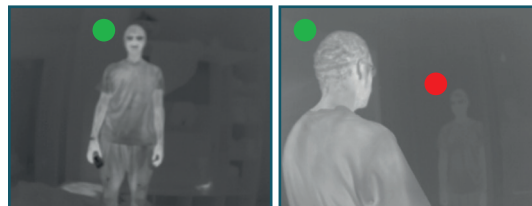
Abbildung 12: (links) Person mit grünem Indikator, (rechts) echte Person mit grünem Indikator und Reflexion mit rotem Indikator.
